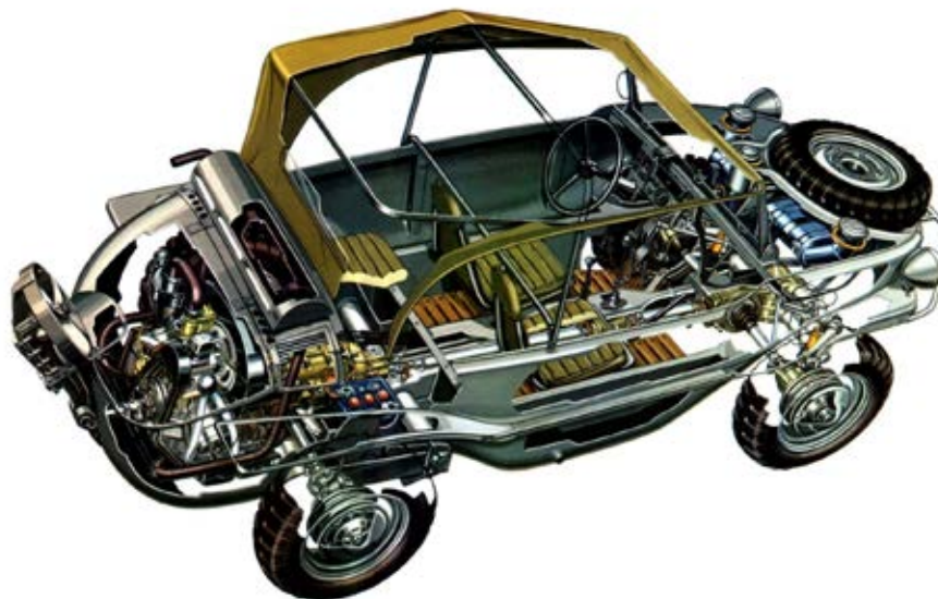
Corte esquemático anfíbio VW Schwimmwagen
