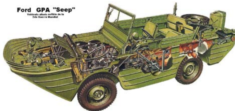
Corte esquemático Ford GPA “Seep”
