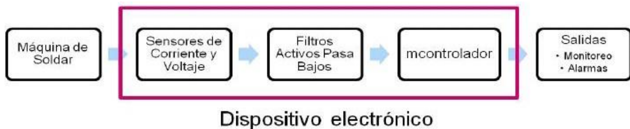
Figura 4. Estructura del dispositivo electrónico para el monitoreo y control del stick out
