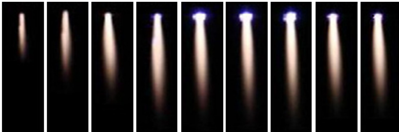
Figura 4. Secuencia de imágenes de la variación de la longitud del chorro de plasma para diferentes velocidades del flujo para un voltaje de 8KV
