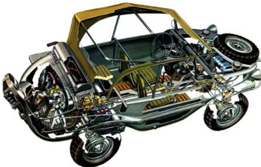
Corte esquemático anfíbio VW Schwimmwagen
