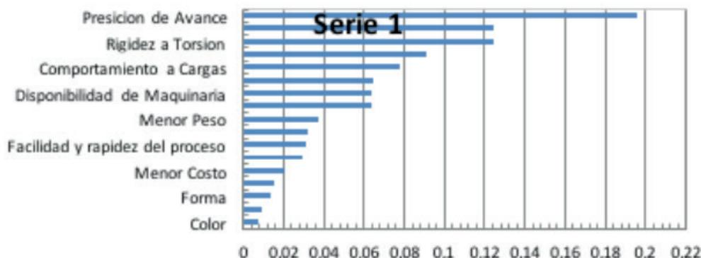
En el grafico 2, se observan los criterios más importantes obtenidos del sistema corrector angular: precisión de avance (19,6%), rigidez a la torsión (12,4%) y rigidez a la flexión (12,4%). Al conocer los pesos de los criterios, se procedió a evaluar los diferentes modelos propuestos mediante matrices comparativas, resultando grafico 3.
