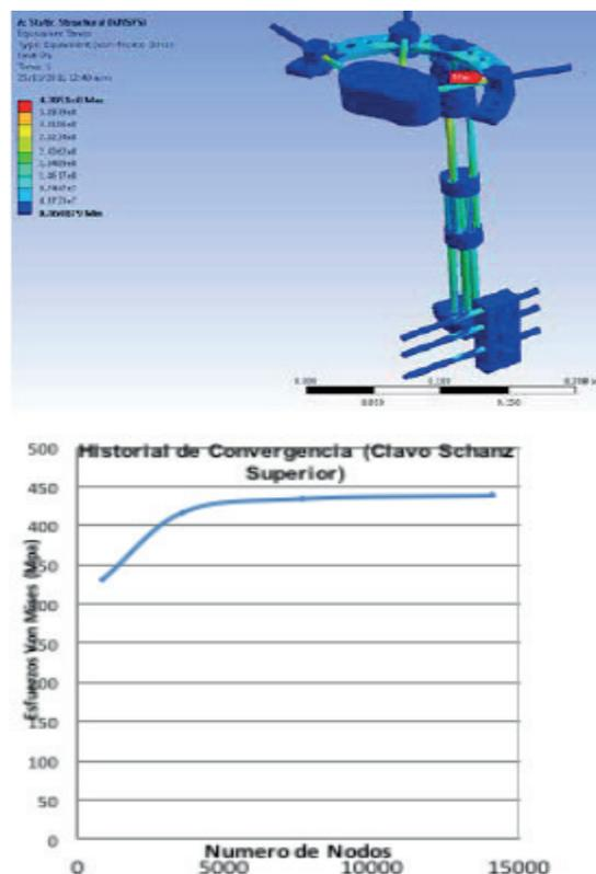
En el análisis estático de elementos finitos se encontró un valor de esfuerzo de Von Mises máximo de 438,5 MPa con un valor de convergencia del 0,93 % obtenido con una malla de 14.131 nodos, ver figura 5. El análisis de fatiga se realizó con la teoría de falla de Soderberg (13), para un periodo de vida finita de 162.000 ciclos, en donde se aplicó una carga axial fluctuante con una variación de 686 N a 0 N.
