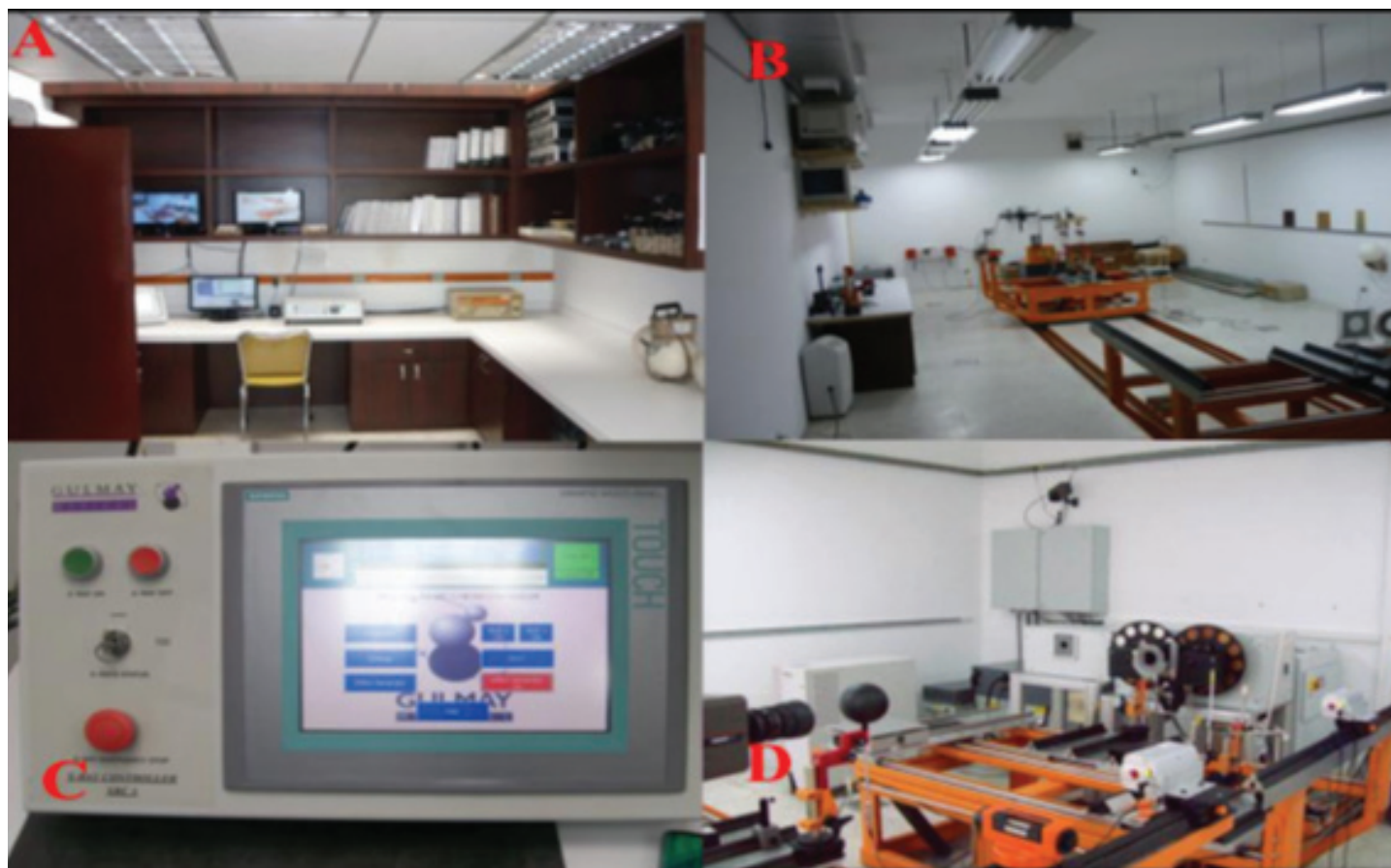
Figura 6. Laboratorio Secundario de Calibración Dosimétrica IVIC, Bunker de baja energía, a) sala de control fuentes, b) Irradiador Cs137 Buchler OB34/1, c) Control Rayos X, d) Equipo de rayos X
