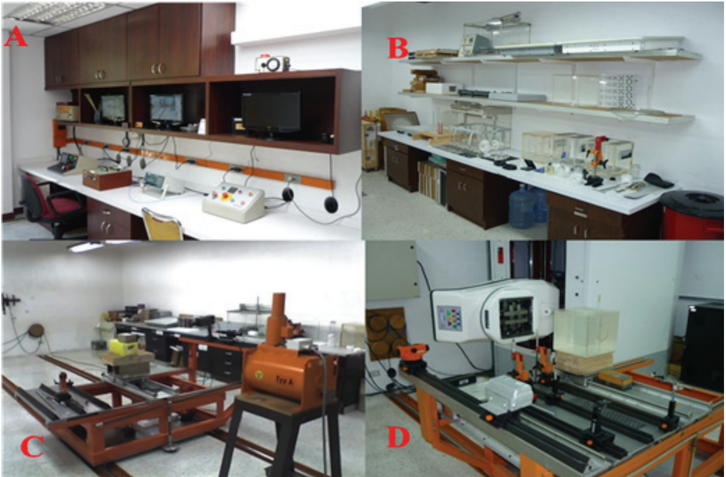
Figura 7. Laboratorio Secundario de Calibración Dosimétrica IVIC, Bunker de alta energía, a) sala de control fuentes, b) Diversos maniquis, c) Irradiador Cs137 Buchler OB6/1, d) Unidad de Co60 Invap Teradi 800
